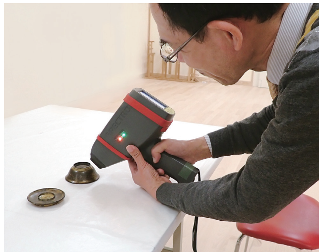
図4 調査の様子。携帯型の蛍光X線分析装置を用い、ろっきにX線を照射して、金属組成を確認する。
